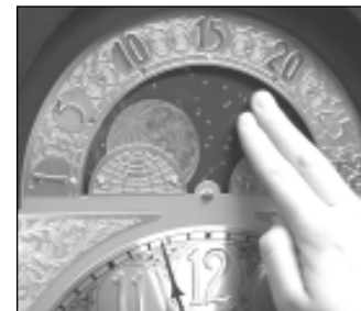
Ajuste del disco de fases lunares
